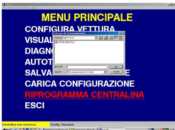
Per poter procedere con la programmazione è necessario selezionare il file contenente il nuovo “Firmware” per la centralina, attraverso una finestra di dialogo. Una volta selezionato il file basta premere il tasto Programma per iniziare l’aggiornamento della centralina.
